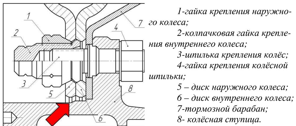
Рис.1. Крепление колес по ГОСТ 10409-74 грузового автомобиля с раздельным креплением внутреннего и наружного дисков.
