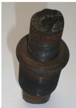
Рис. 6. Шпильки, сломавшиеся во вторую очередь
