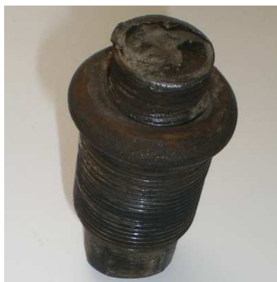
Рис. 5. Шпилька, сломавшаяся в первую очередь (вид с двух сторон)
