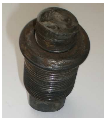
Рис. 5. Шпилька, сломавшаяся в первую очередь (вид с двух сторон)
