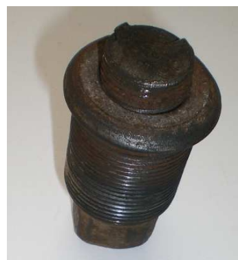
Рис. 6. Шпильки, сломавшиеся во вторую очередь
