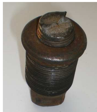
Рис. 7. Шпильки, сломавшиеся в последнюю очередь
