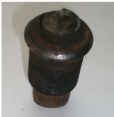
Рис. 6. Шпильки, сломавшиеся во вторую очередь
