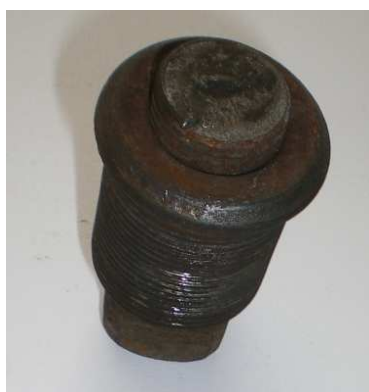
Рис. 7. Шпильки, сломавшиеся в последнюю очередь
